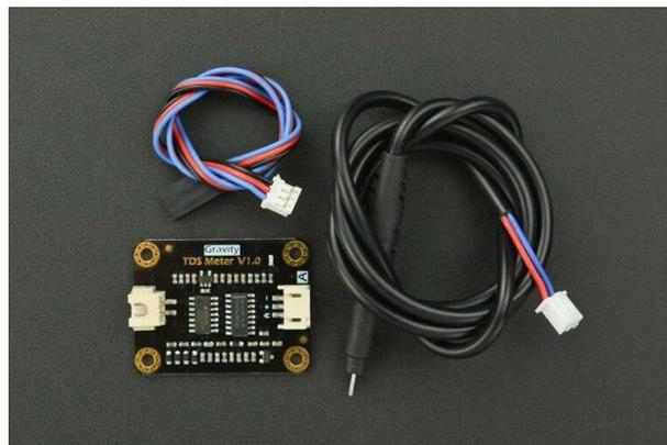
Gambar 8 Sensor TDS (*Total Dissolved Solids*) dari widodo *et al* (2020)
